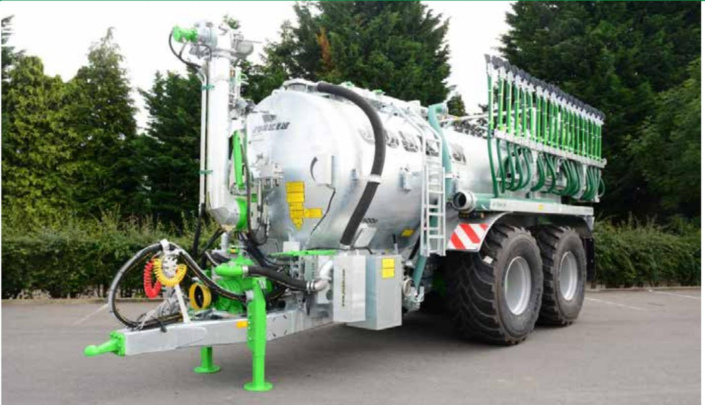
Der Erfolg der Volumetra-Baureihe hat die Firma JOSKIN dazu veranlasst, eben jene Baureihe zu erweitern. Ursprünglich wurde das Fahrzeug entwickelt, um eine volumetrische Pumpe (Exzentrerschneckenpumpe, Drehkolbenpumpe,...) optimal verbauen zu können. Ab sofort ist das Volumetra ebenfalls in der **Vakuum-und Vaku-Stormversion** (Kombination aus Vakuumpumpe zum Ansaugen und Zentrifugalpumpe zum Ausbringen) erhältlich.
